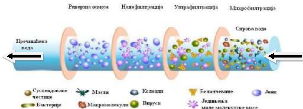
Слика 12.17. Уклањање супстанци различитим процесима филтрације
