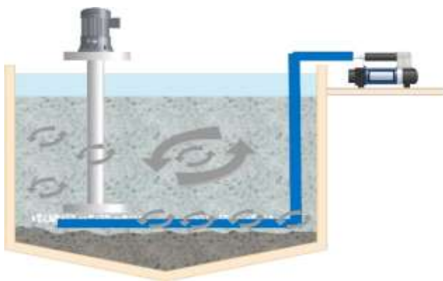
Слика 12.6. Принцип рада механичког аератора
