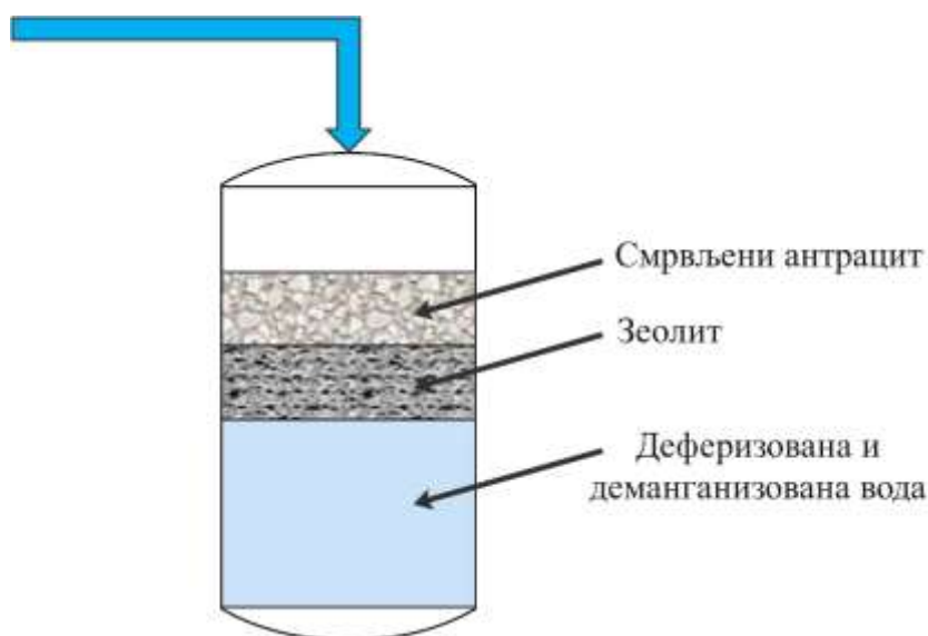
Слика 12.5. Деферизација и деманганизација воде зеолитом
